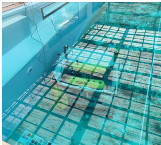
*Transmisión de los datos recopilados y recarga de las baterías en la DS*
